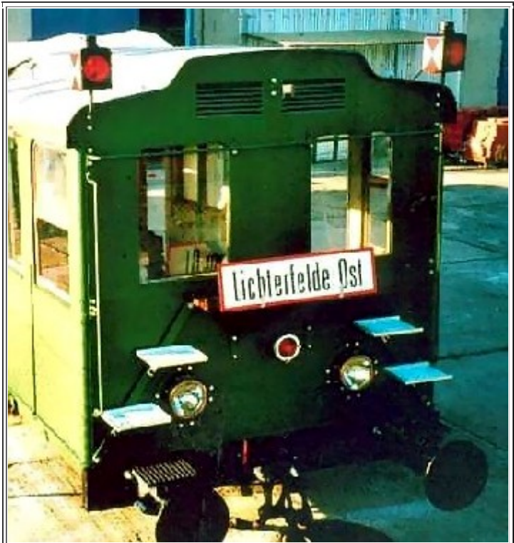
Eisernerer Probewagen für die A.E.G- Schnellbahn nach dem Umbau in der Hauptwerkstatt Tempelhof, 1921
